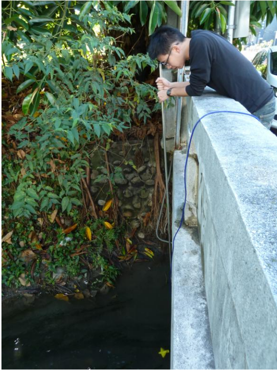
圖 3.1-1 以旋槳式流速儀量測流速 (豐榮二橋測站)
